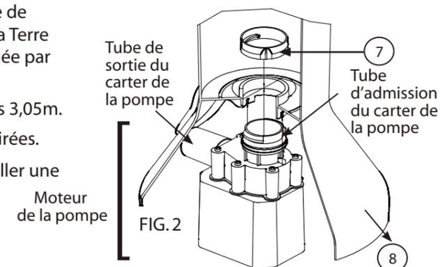
**NOTE** - Le motofiltre comprend quatre sections: une motopompe; ensemble filtrage; un sac de quincaillerie; et tuyau d'aspiration /de refoulement.
