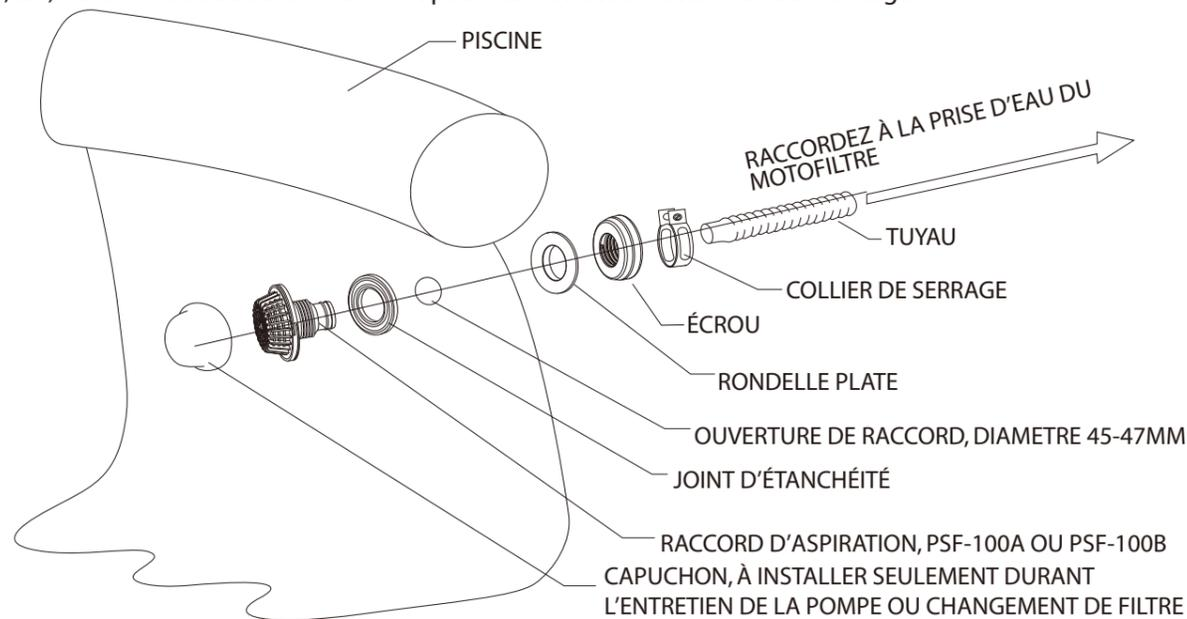
(9) Les orifices d'aspiration PSF-100A ou PSF-100B doivent être remplacés chaque 5 ans.
